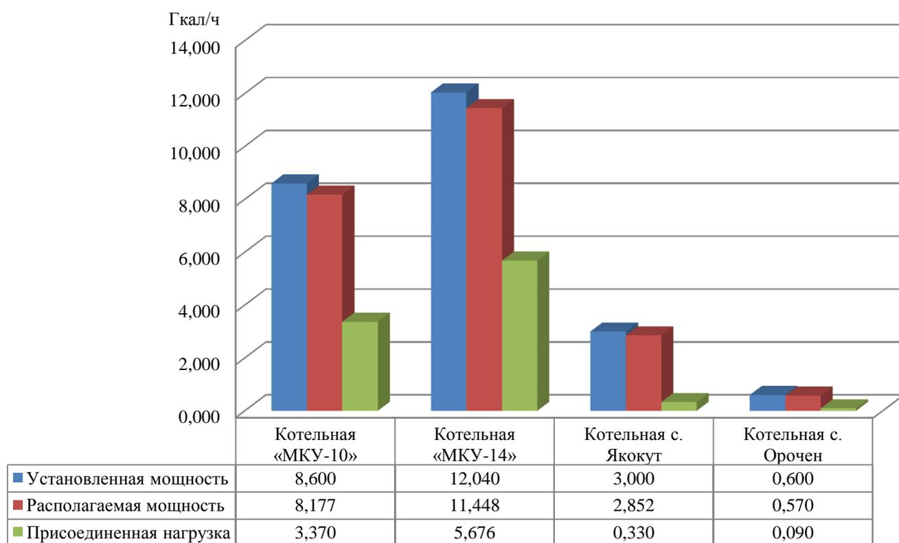
Рис. 1.2 – Распределение мощностей источника тепловой энергии
